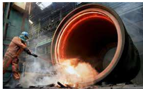
図6. 鋳鉄管遠心力鋳造(1953年～) 出典：(株)クボタHPより
